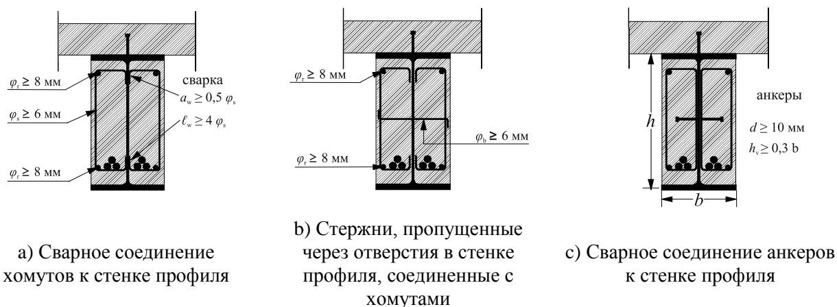
Рисунок 11.1 - Мероприятия, обеспечивающие объединение стального двутавра с бетоном [СН РК EN 1994-1-2:2004/2011]
